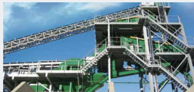
STICHWEH-Обогатительная установка, состоящая из: ДВУХДЕКОВАЯ ПРОСЕИВАЮЩАЯ УСТАНОВКА VS 24/60 ДВУХДЕКОВАЯ ПРОСЕИВАЮЩАЯ УСТАНОВКА VS 21/60 Черпальные колеса E 4009 LA Обезвоживающее сито Eb 12/35-03
