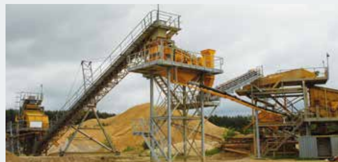
STICHWEH-Обогатительная установка, состоящая из: ОДНОВОДЕКОВАЯ ПРОСЕИВАЮЩАЯ УСТАНОВКА VS 15/40 ДВУХДЕКОВАЯ ПРОСЕИВАЮЩАЯ УСТАНОВКА VS 24/60 ТРЕХДЕКОВАЯ ПРОСЕИВАЮЩАЯ УСТАНОВКА VS 15/50 Промывочная Машина с двумя валами DSW 120/2100/6000 Обезвоживающее Сито Eb 09/25-1
